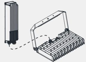
R2 con Driver montato sulla staffa tramite accessorio
