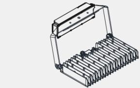
R2 con Driver montato sulla staffa tramite accessorio
