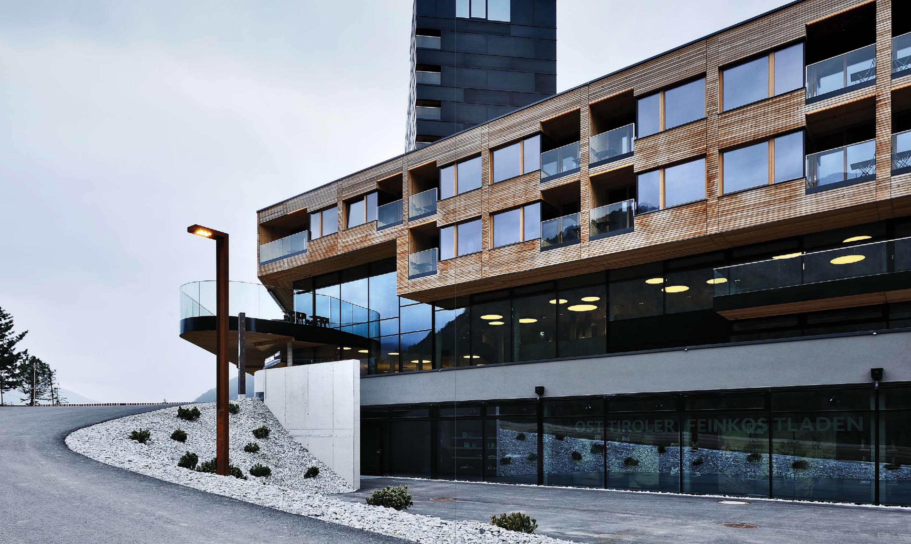
Strahlprofile mit einheitlicher Patina, erzielt in einem mehrstufigen Prozess, und spezielle Lichtfarbe dank Überzug der Linsen mit bernsteinfarbenem Lack
