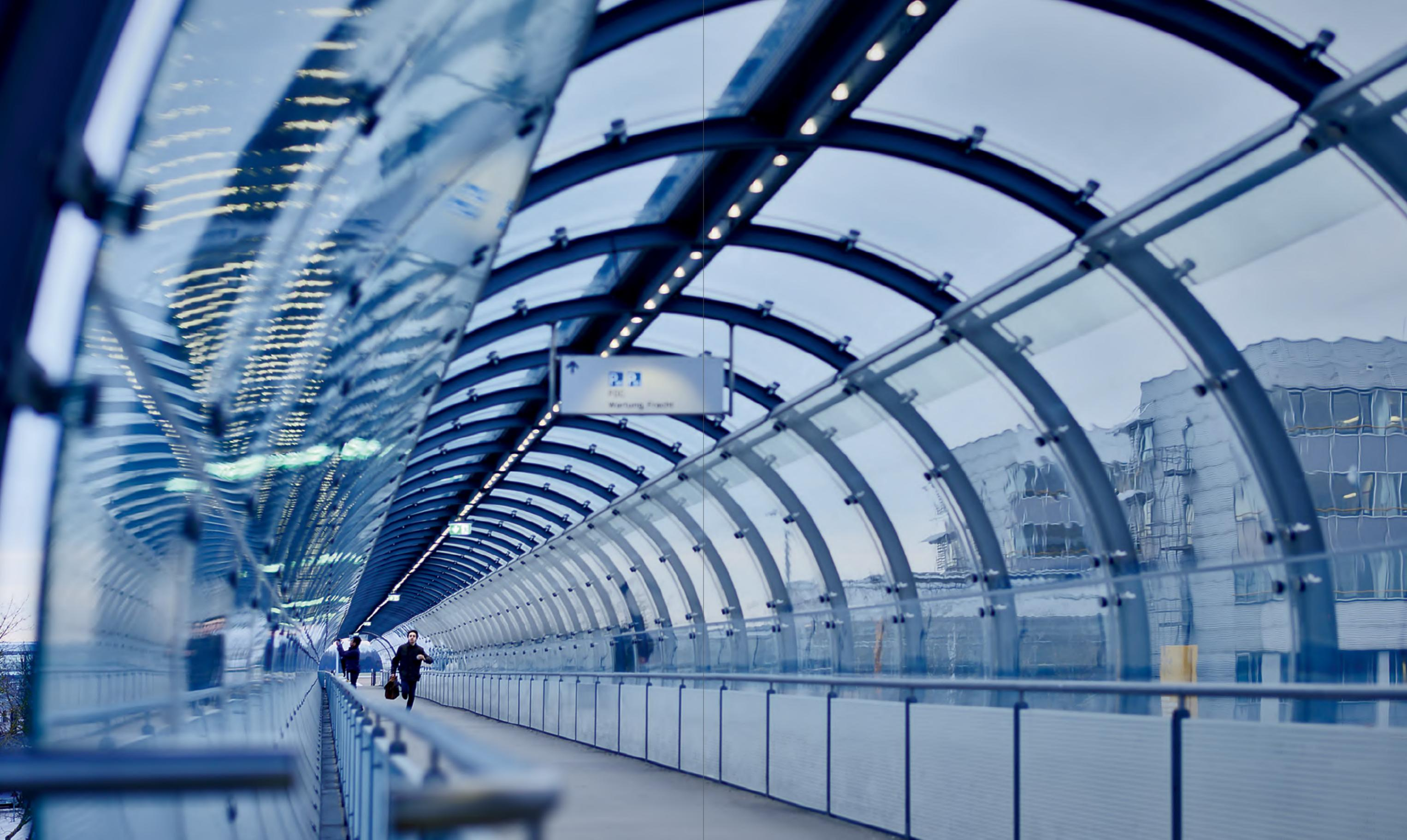
141 apparecchi speciali con sistema di controllo illuminano, con 150 lx in 4.500 K, i 300 m della passerella (conforme alla norma DIN EN 12464-1)
